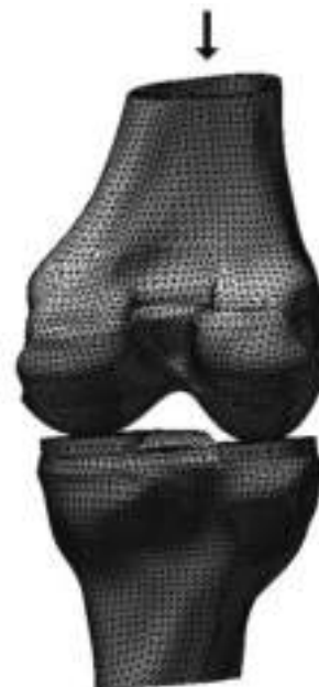
Рис. 4. Конечно-элементная модель кинематической цепи
