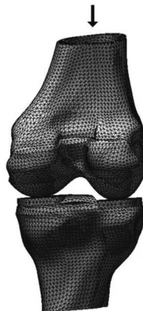
Рис. 4. Конечно-элементная модель кинематической цепи
